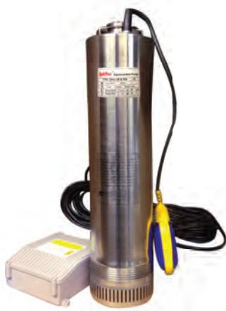
Насосы серии SPm имеют вертикальный напорный патрубок. Отверстия для забора воды расположены в нижней части насоса. Данная конструкция позволяет оставлять низкий уровень воды на дне колодца. Оснащены поплавковым выключателем для защиты от сухого хода. Укомплектован пультом управления. Длина кабеля – 15м
