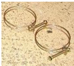
Хомуты крепления гофротрубы подачи топлива
